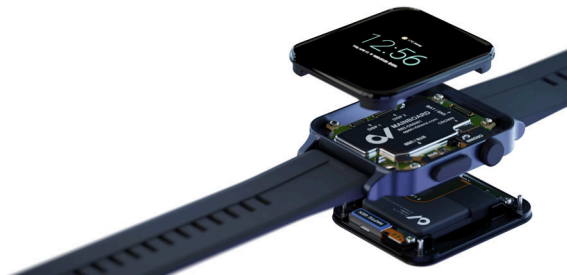
Ultrakompakte Leiterplatten kommen in Wearables wie Smartwatches zum Einsatz.
